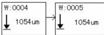
屏显结果只能被存储一次，如需另外存储可重新测量。如果要从初始地址重新开始存储可以在存储读出菜单下长按“ENTER”键，储存序列号就会回归至初始地址 0001，即可开始重新储存。
