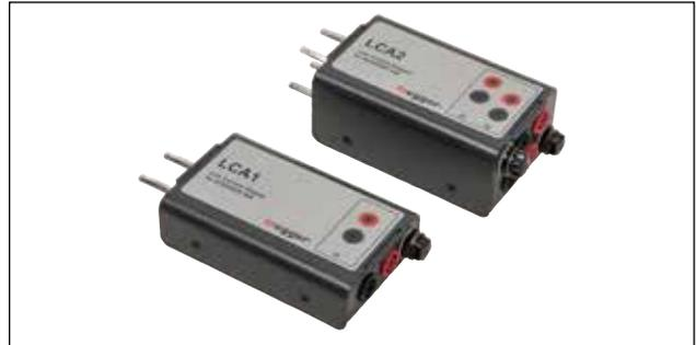
低电流适配器，用于产生低电流 (0 - 30mA)，用于测试例如灵敏的接地故障保护、电容不平衡保护和反向潮流保护。(CR-90010)
