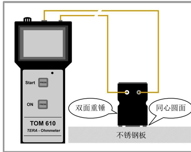
把双面重锤的同心圆面向下，放置在不锈钢板上，检测系统电阻( $<1\text{K}\Omega$ )
