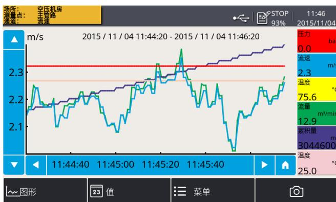
S 551采用的高分辨率5英寸彩色触摸屏界面让操作简单易行。电源开启时自动识别CS-ITEC智能传感器。简单设定后即可开始数据记录, 存储容量近乎无限大。
