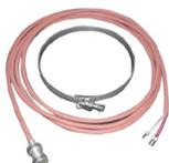
S604 0107 温度传感器, PT100, 3线, 外夹式, 含安装器(能量计算时需要2个传感器)
