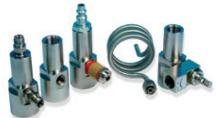
DMT242SC2, DMT242SC和DSC74的采样室(左起)可以直接用来将DM70与样气流连接。DSC74B(右)是一种双压力采样室，可用于带压或常压测量。DSC74C采样室含有冷却/泄露螺旋，但是属于选配范围。
