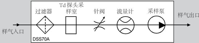
DSS70A采样系统的过滤器可清除样气杂质, 针阀则利用流量计对样气流速进行控制。采样泵在环境压力下从生产过程中生成样气气流。
