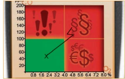
testo 330 LL 传感器寿命长达6年，用户可自行更换传感器，无需校准。其测量菜单众多，可对供热系统进行全面分析，烟气矩阵功能大大简化了测量数据的分析工作。
