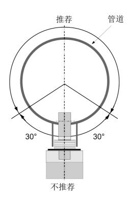
请按照图示,只在此区域内安装传感器。不能倒着安装,请确保安装点和垂直线保持一定距离>30°。
