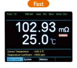
GOM-804/805 提供了 2 种测量速度-快速: 可达每秒 60 个读值/慢速: 每秒 10 个读值。不同于以往,用户必须在速度和显示分辨率间进行取舍,在 GOM-804/805 上,不管选择的速度为何,都会维持最高的分辨率;即读值分辨率不会因为速度的改变,而造成分辨率下降的情况。
